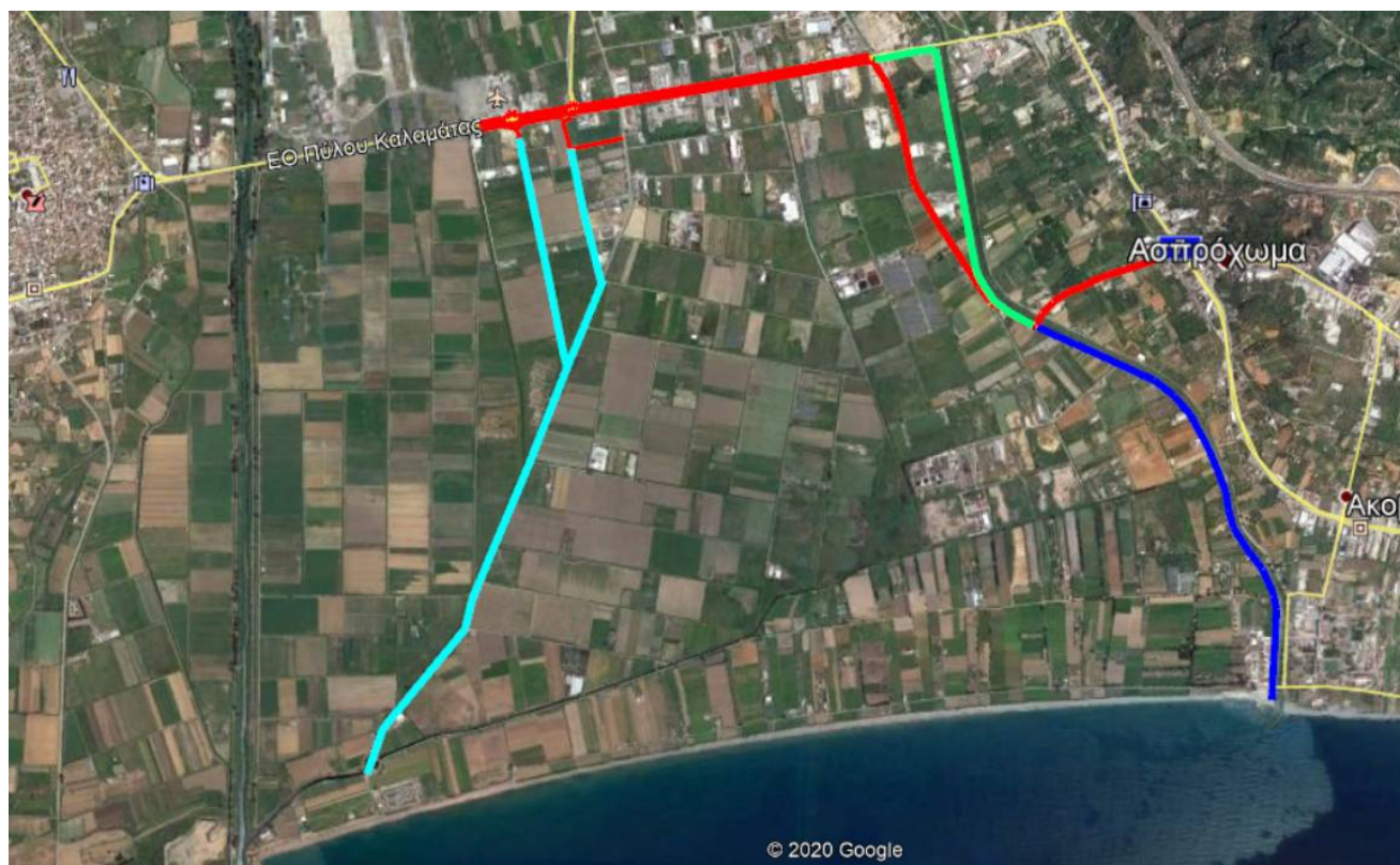
Εικόνα 5: Με γαλάζιο σημειώνεται ο υφιστάμενος δρόμος που θα πρέπει να αναβαθμιστεί καθώς και οι 2 εναλλακτικές προσεγγίσεις για το αρχικό του τμήμα
