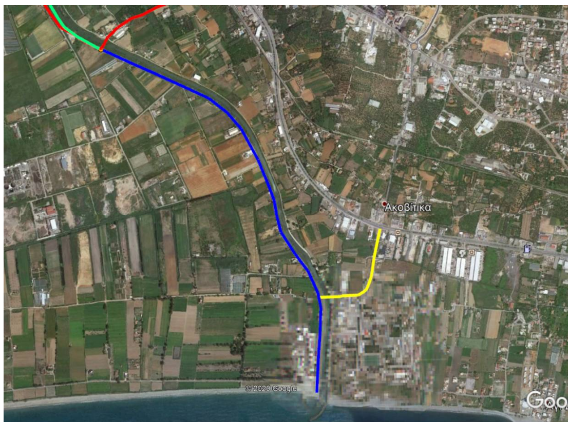
Εικόνα 4: Με μπλέ χρώμα ο υφιστάμενος δρόμος που προτείνουμε να διαπλατυνθεί και να διαμορφωθεί κατάλληλα ώστε να αποτελέσει είσοδο-έξοδο της πόλης. Με κίτρινο χρώμα εναλλακτική σύνδεση του υφιστάμενου δρόμου με την οδό Ηρώων Πολυτεχνείου (Νέα είσοδος)
